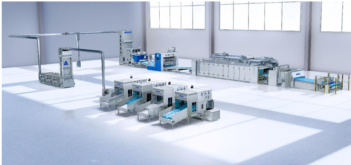
neXline airlay zur Produktion von langlebigen Vliesstoffen im Bereich von Automotive, Gebäudeisolierung und Matratzen
